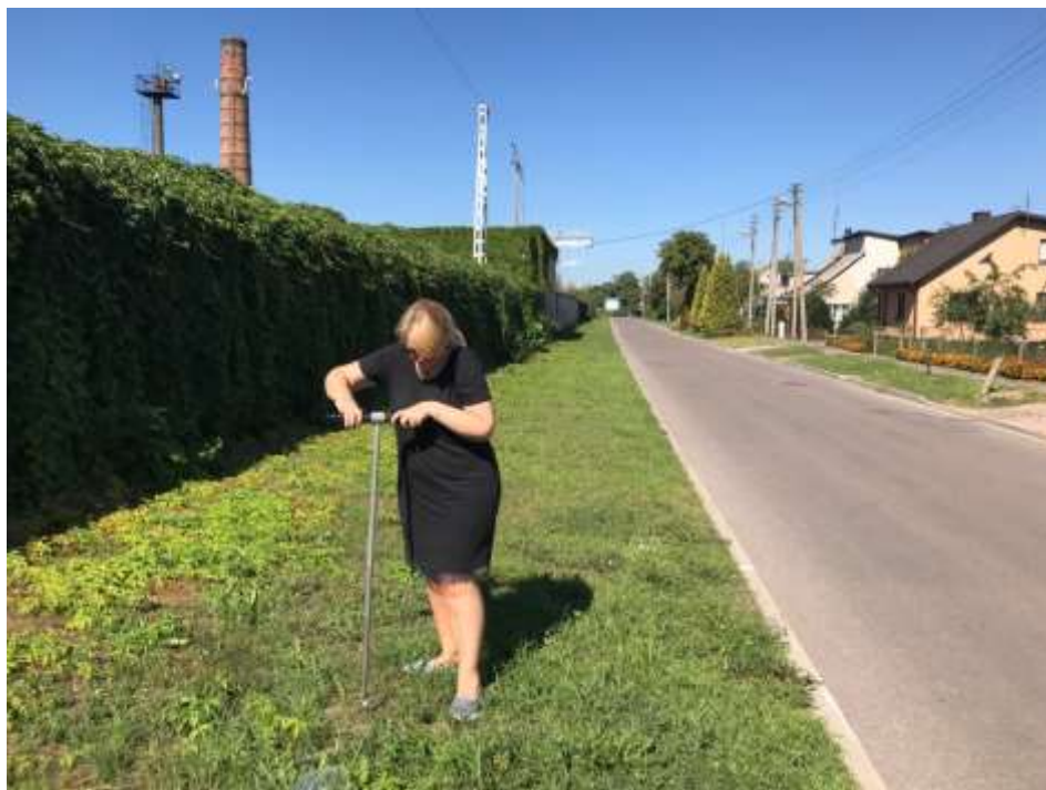
4 pav. Dirvožemio ėminių rinkimas Alytaus AB mašinų gamyklos „Astra“ teritorijoje Gamyklos g.1
